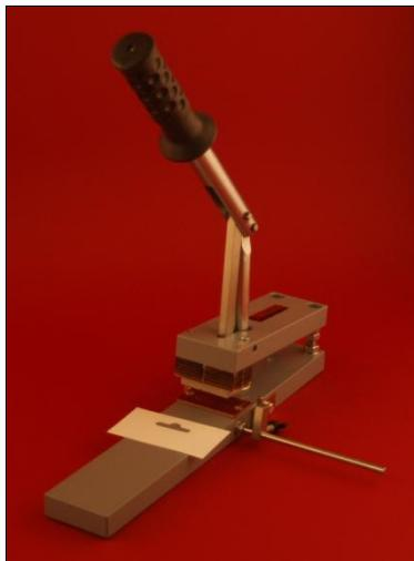
Вы можете легко вырубить стандартное отверстие под евро-слот с помощью нашего аппарата. Помимо наиболее популярной односторонней формы отверстия, как показано на рисунке, также, путем замены формы вы можете вырубить и симметричное 2х стороннее отверстие под евро-слот либо оригинальное по собственному заказу.
