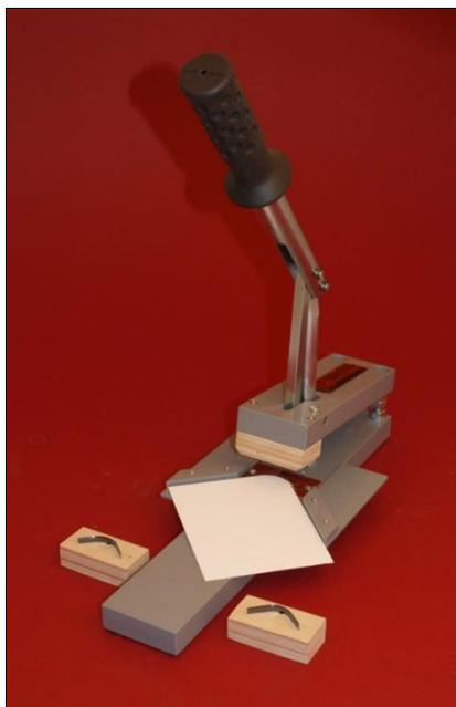
С помощью дополнительных направляющих и тул для обрезки Вы можете превратить Ваш вырубщик в обрезчик углов (диаметры тул для скругления от 4 до 20 мм).
