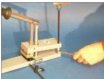
Ослабьте винты М8 на обратной стороне аппарата, как показано на рисунке, отрегулируйте параллельность до получения правильной вырубki, затем затяните винты.
