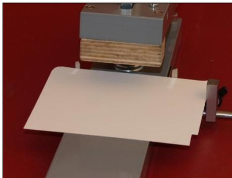
В зависимости от вида работ установите направляющие так, чтобы вырубка происходила точно в намеченном месте. В результате длительного использования и режущий тул и марзан будут постепенно изнашиваться. В случае снижения качества вырубки Вам следует заменить их.
