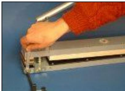
Возьмите ограничитель (1) и зафиксируйте на направляющих (2), которые затем вкрутите до упора в имеющиеся резьбовые отверстия.
