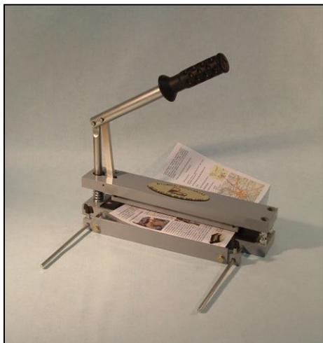
На цилиндрических направляющих нет линейки, что не позволяет осуществить точное позиционирование ограничителя при тиражной работе. При необходимости Вы можете дополнительно приобрести рабочий стол и установить его вместо простых направляющих.
